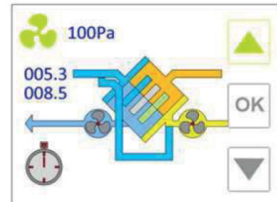
změna otáček ventilátorů pomocí nastavení tlaku
